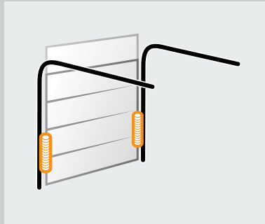
BZ-Beschlag: Zugfeder-Beschlag mit Zugfeder-Technik und flächenbündiger Blende
